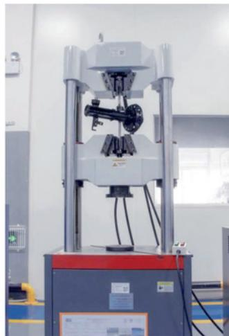
*Macchinario per la prova di trazione.*
